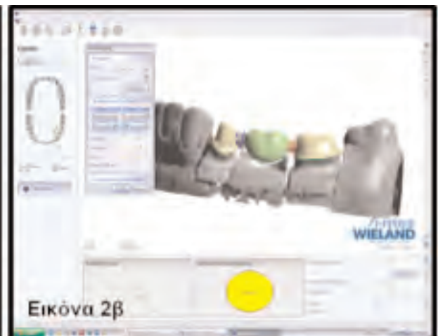
Εικόνες 2α και 2β. Σάρωση και σχεδιασμός σκελετού ζirkονίας οπίσθιας κάτω γέφυρας με τη μέθοδο CAD-CAM.
