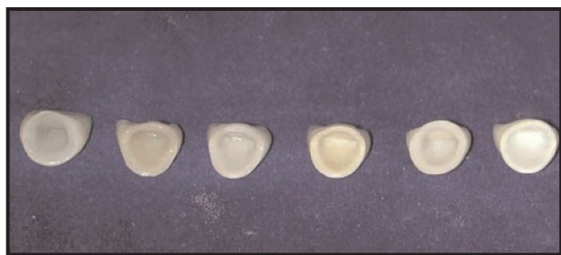
Εικόνα 5. Ολοκεραμικές στεφάνες, ταξινόμηση με βάση τη διαφάνεια, μειωμένη από αριστερά προς τα δεξιά: χυτευόμενο υαλοκεραμικό (Dicor), θερμοσυμπιεζόμενο κεραμικό (IPS Empress), θερμοσυμπιεζόμενο κεραμικό (OPC), κεραμικό διάχυσης (In-CERAM Alumina), κεραμικό διάχυσης με σπινέλλιο (In-Ceram Spinnel), κεραμικό ζirkονίας CAD/CAM (Procera Zirconia). Φωτογραφία από Spear και Holloway 2008 131 .
