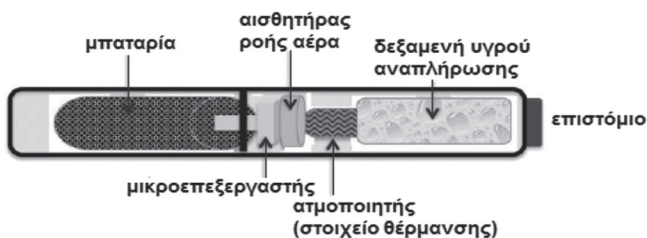
Εικόνα 1. Σχηματική απεικόνιση της δομής του ηλεκτρονικού τσιγάρου.
